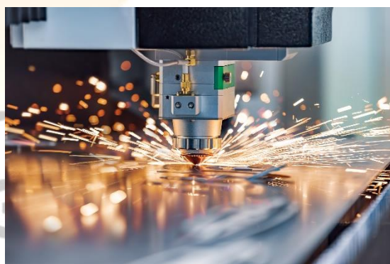
ماكينة القطع بالليزر CNC
